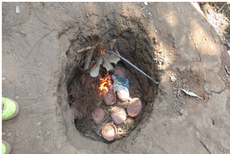
Figura 1. Potes de argila em queima primitiva de buraco. Fonte: Cintia Valente
